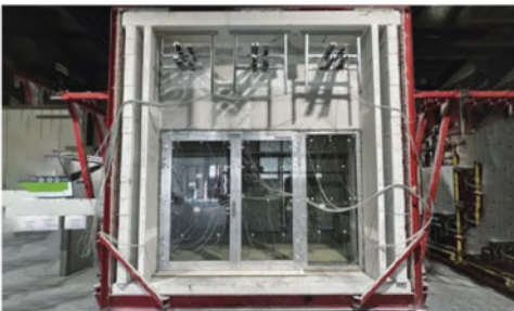
Für die Prüfung wurde die Brandschutztür FireStop ADS 90 FR 90 in einer typischen Einbausituation mit beidseitig senkrecht verlaufenden Flurwänden eingebaut.
